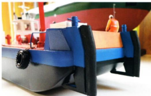
Fertige Schubdälben mit D-förmigem Moosgummifüßern
