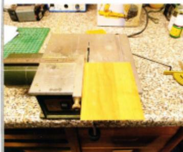
Die Decksplanken werden gesägt. Eine GFK-Platte mit Decifex-Folie beklebt sorgt für die Holzoptik
