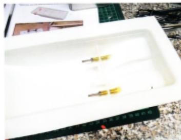
Der Motorspant mit aufgesetztem Servo-Halter und eingeklebte Wellen
