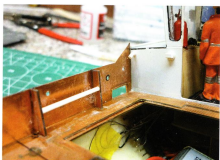
Verstärkungen um die Speigatten werden aus Draht einfach angelötet – und der Steuermann hat auch schon seinen Platz
