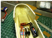
Eine Akkutasche aus GFK-Platten ...
