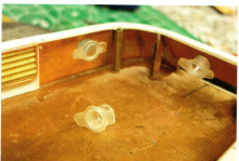
Die Klüsen mit Belegklampen wurden aus Kunststoff abgossen
