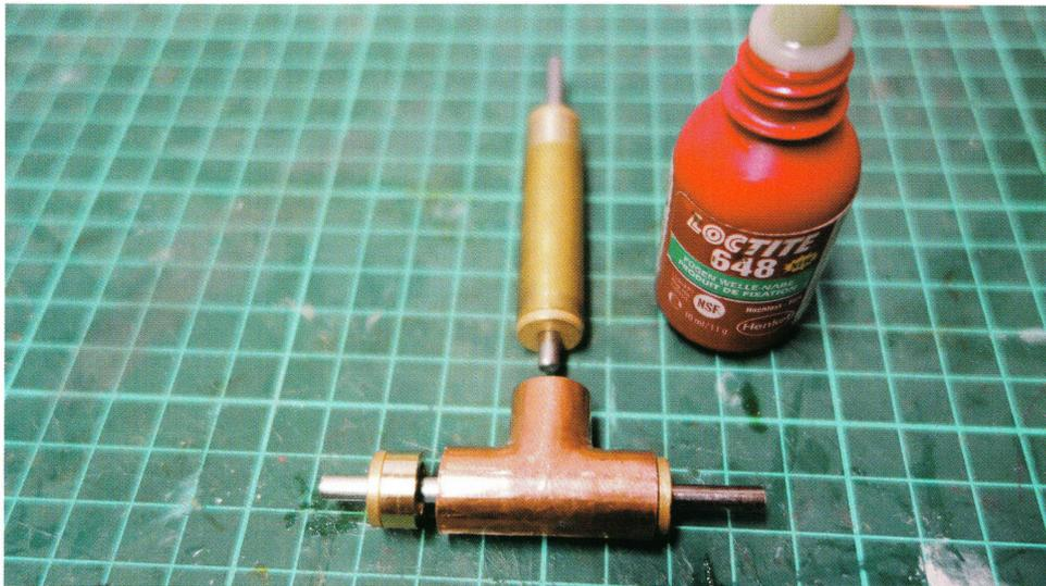
Ausrichten und verkleben des Sinterlagers mit Loctide. Das zweite bleibt frei zur späteren Verklebung
