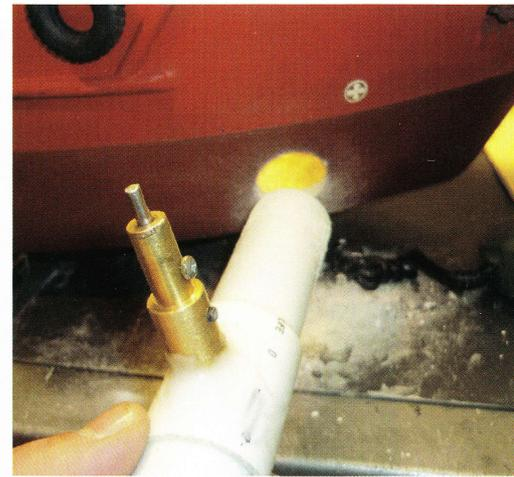
**Der komplett verklebte Antrieb mit Flutkanal, bereit zum Einbau in den Rumpf**
