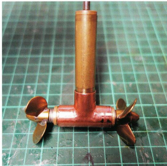
**Der fertige Bugstrahler mit je zwei gleichläufigen Propellern. So kann das Bugstrahlruder in den Flutkanal im Schiff eingebaut werden**
