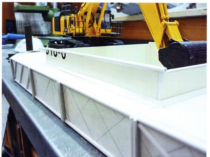
U-Profile als Aufnahme für die Fendergummis. Den Rand des Ladekastens umläuft ein 3-mm-Rohr
