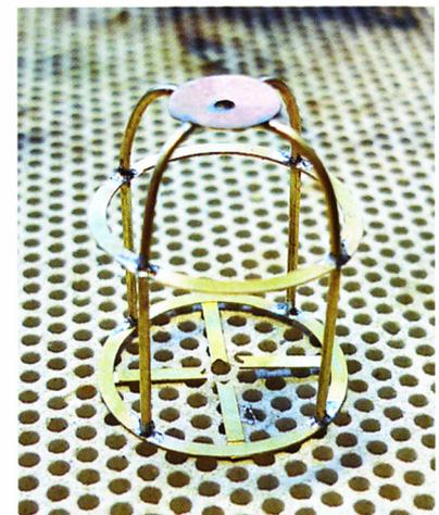
Der Korb wird aus 0,6-mm-Messingdraht gebogen
