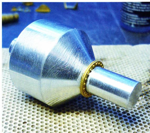
Ring mit Bolzen am Fuß des Schwimmkörpers
