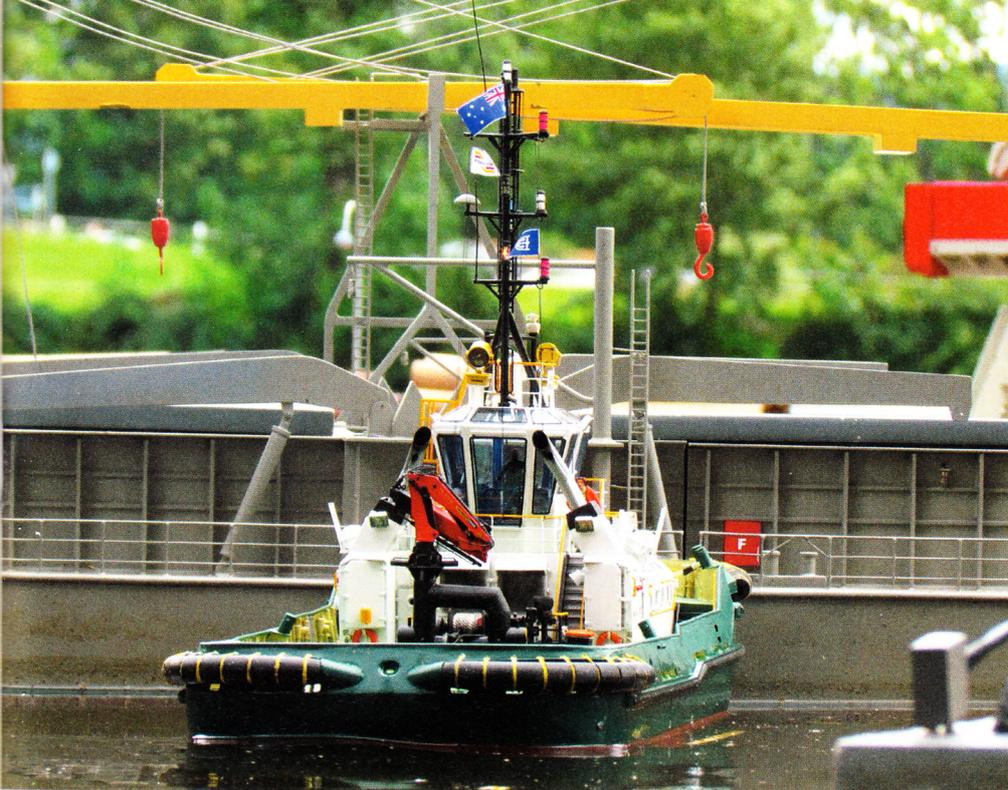
Material ist recht steif, daher der kleinere Durchmesser zum Rundbiegen. Selber löten wollte ich die Körbe nicht, da kein  $0,2 \times 1$ -mm-Messing im eigenen Materiallager vorrätig war. Am Original sind es flache Bandeisen, die miteinander verschweißt werden. Da das Radar funktionsfähig sein sollte, wurde ein Rohr, auf dem das Gerät sitzt, so verändert, dass es den Motor mit Welle aufnehmen konnte. Das Radargerät selbst war ein fertiges Resinteil aus meinen Beständen.
