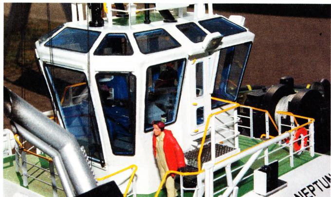
Die Verglasung wurde mit Klarlack am Brückenhaus befestigt. Das Lackieren der Rahmen erforderte einige Geduld
