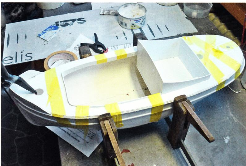
Aufkleben des Decks: Fixierung mit Klebeband und Informdrücken des Rumpfes mit Schraubzwingen
