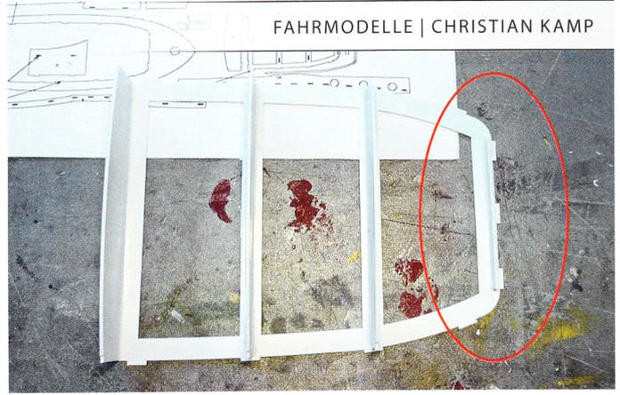
Mein Baufehler! Der erste Spant gehört unter die Bodenplatte geklebt, nicht darauf
