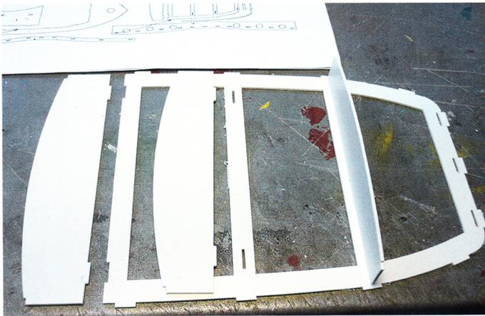
Unterkonstruktion für Kajüte mit drei Spanten
