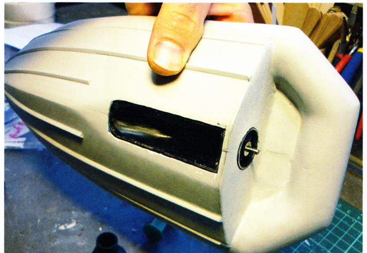
Anhand der zuvor angebrachten Markierung wurde der Jet-Antrieb im Rumpf eingelassen
