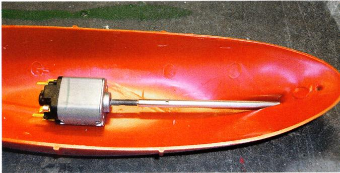
Motor und Welle probeweise eingebaut
