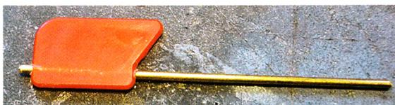
Das Ruder wurde aufgebohrt und mit einem 1,5-mm-Messingdraht als Welle verklebt
