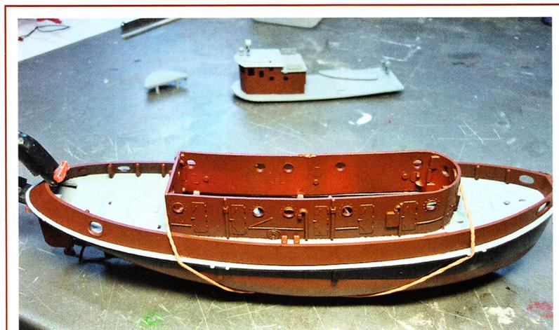
Verklebung des Schanzkleids mit Hilfe von Gummibändern
