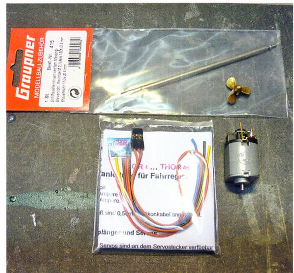
▲ Motor, Regler, Schraube und Welle
