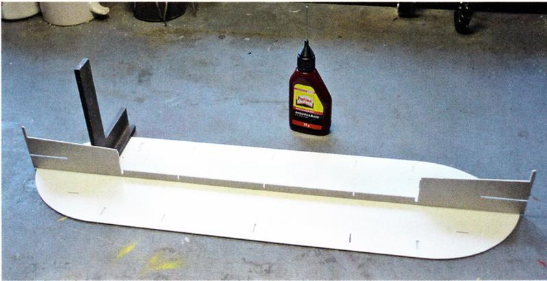
Der längs angebrachte Mittelspant
