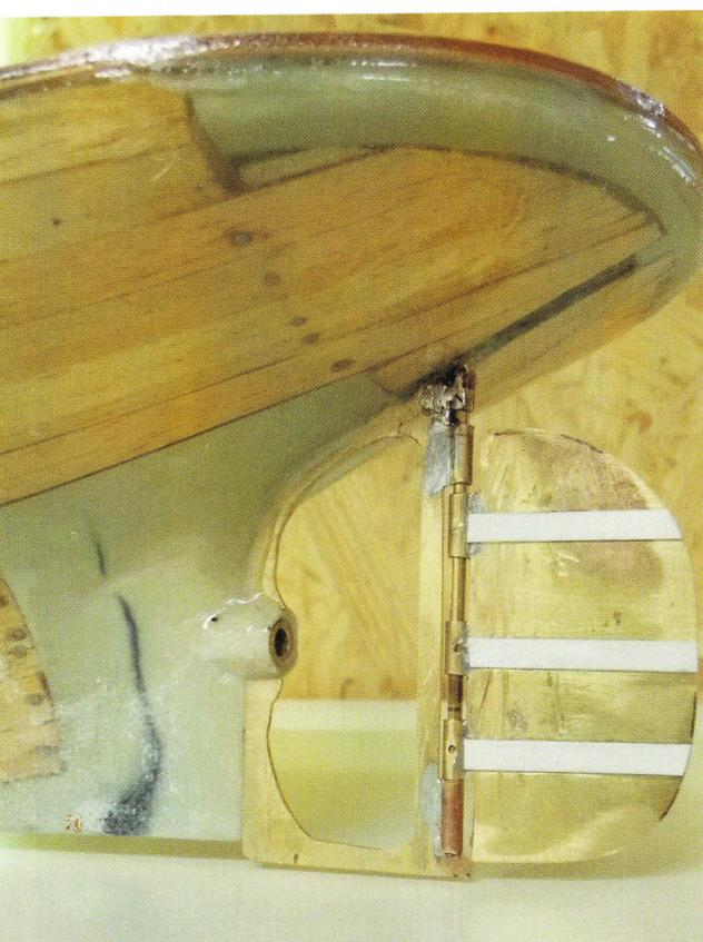
Das Ruder und die Hacke musste ich aus Messing ersetzen, da die dem Kasten beiliegenden Teile unbrauchbar waren
