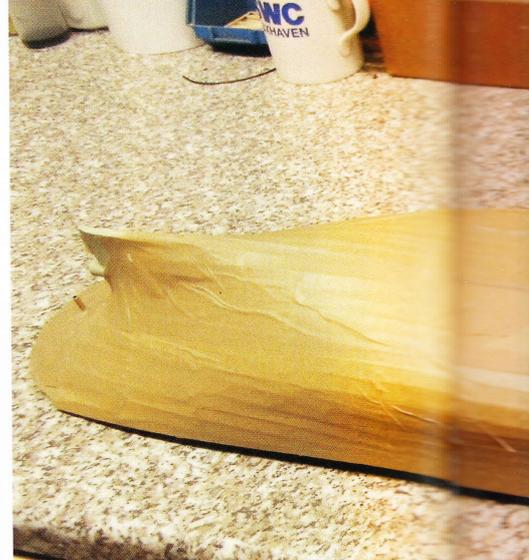
Die Außenabklebung mit Kreppklebeband, damit das Harz bei Auslaminieren des Inneren Rumpfes nicht ausläuft
