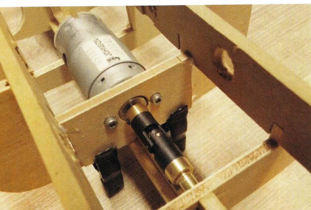
Der Motorspant wird mitsamt Motor und Welle eingeklebt. So ist später alles exakt in einer Linie
