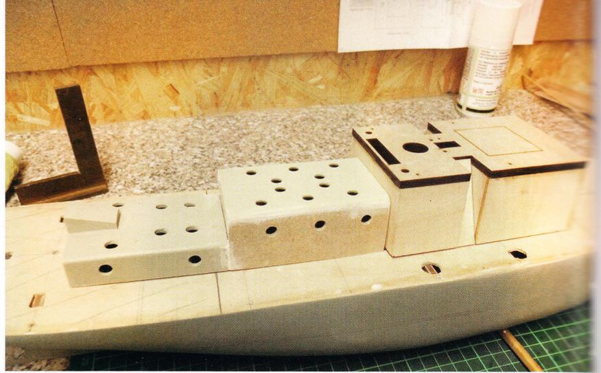
Die Aufbauten stehen an Deck. Vier verschiedene Materialien, die nachbearbeitet werden müssen, um nach dem Lackieren eine glatte Oberfläche zu haben
