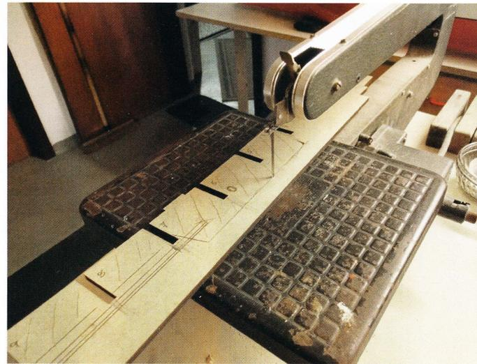
Das Aussägen des Kiels für Motor und Welle
