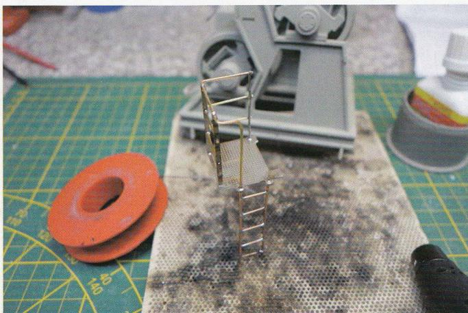
Aus den gelieferten Ätzteilen und 0,8-mm-Messingdraht entstanden die seitliche Plattform und die Leiter der Winde
