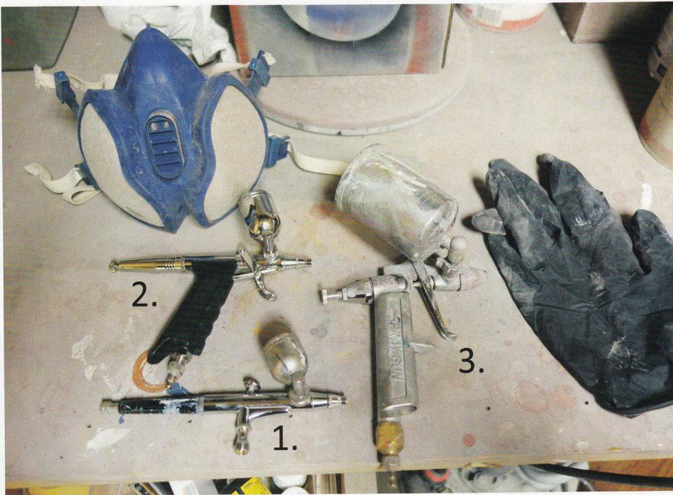
Meine Pistolen. 1. Airbrush mit 0,3 mm Düse und 4 ml Topf, 2. mittlere Airbrush mit 0,5 mm Düse und 11 ml Topf, 3. Lackiererpistole mit 0,8 mm Düse und 125 ml Topf
