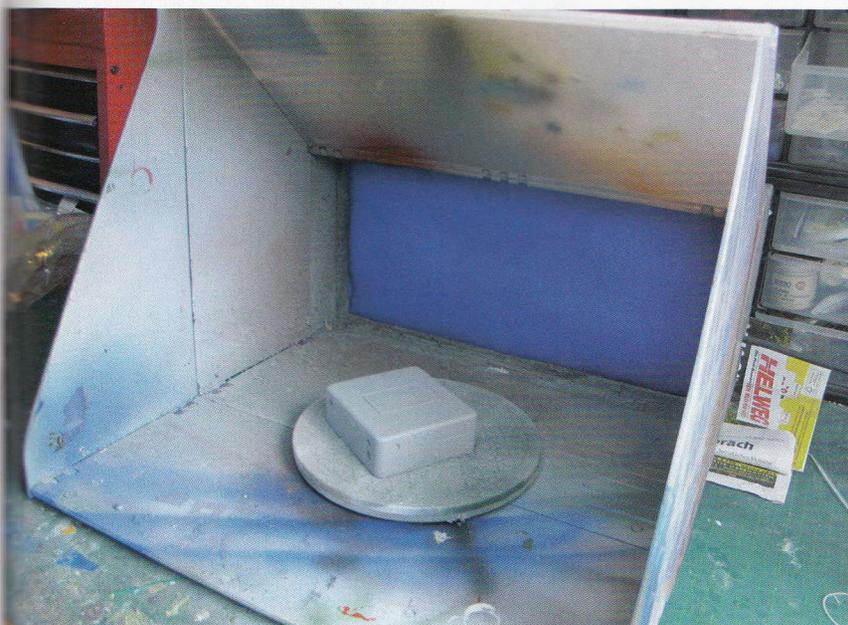
Eine einfache Tischkabine mit Filter und Absaugung der Luft durch die Rückseite
