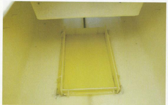
Das einlamierte Eigenbau-Akkufach für den 12V-/15Ah-Blei-Gel-Akku
