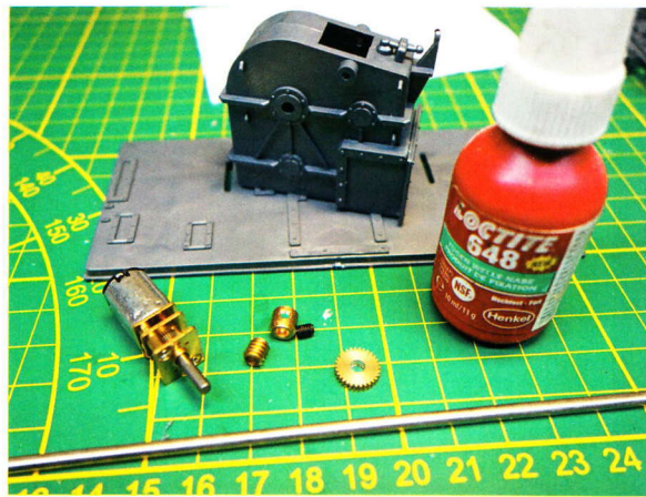
Loctite 648 ist ein Metallkleber, der das Zahnrad und die Schnecke hochfest auf den Wellen fixiert
