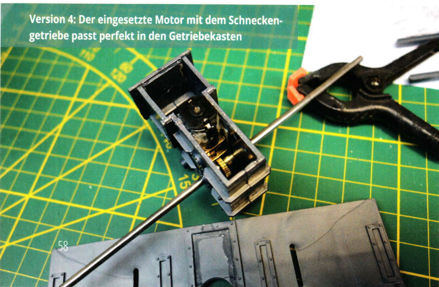
Version 4: Schnecke und Zahnrad wurden leicht gefettet
